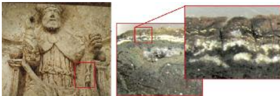
Fig. 6 Scultura del vescovo: sezione sottile della finitura a foglia d'oro.
