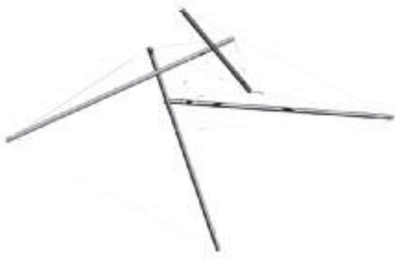
Modulo fondamentale della copertura – struttura in acciaio strutturale (aste compresse – diametro 10cm) ed acciaio inox (tiranti).
