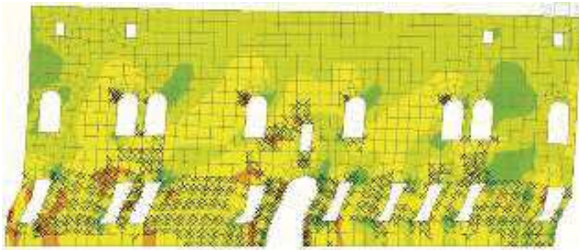
Fig. 21 Simulazione di fessurazioni orizzontali.
