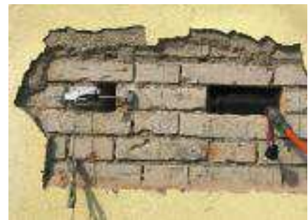
Fig. 5 Prova con martinetti piatti e prova di scorrimento.
