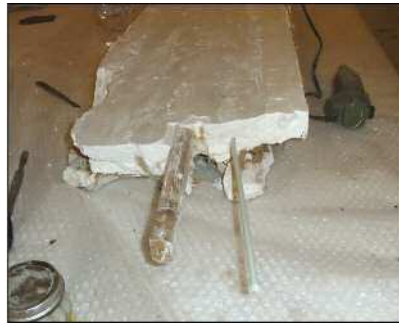
Fig. 14 Sostituzione delle armature ammalorate con tondini in vetroresina.
